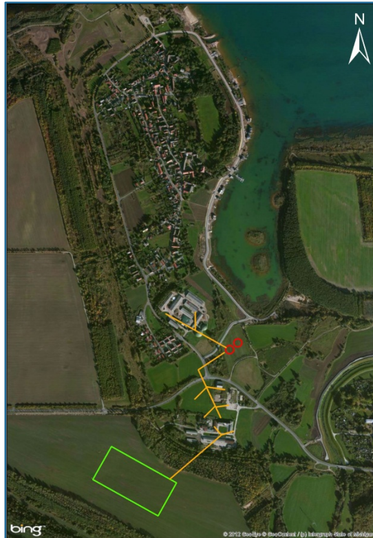
Abbildung 8-10 Skizze des geplanten Nahwärmenetzes im Süden von Kahnsdorf (Oettinger 2013)
