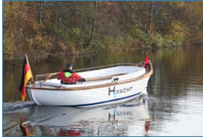
Abbildung 10-14 Brennstoffzellenbetriebenes Boot (NOW 2013)
