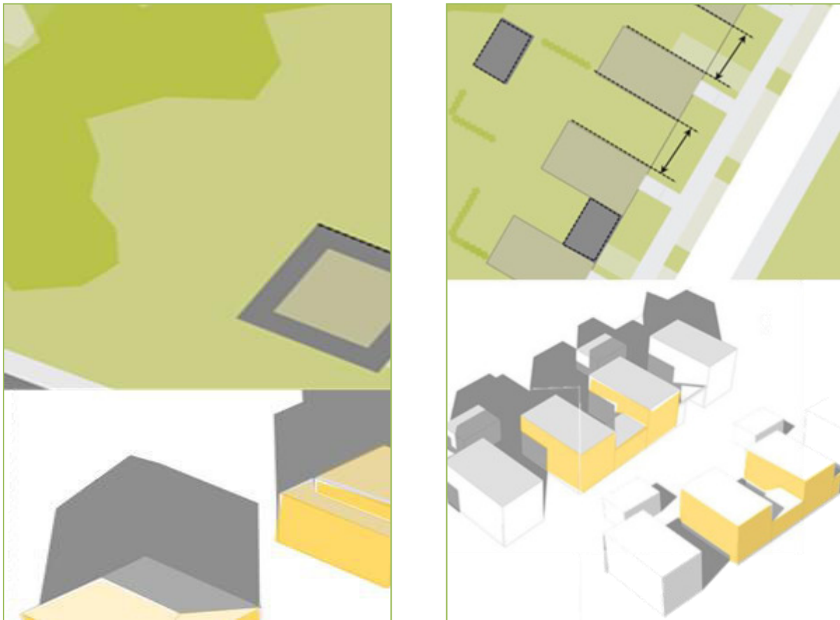
Abb. 36 klimaangepasste Bauweise städtebaulicher Varianten – Schwerpunkt Ausnutzung solarer Gewinne, seecon Ingenieure
